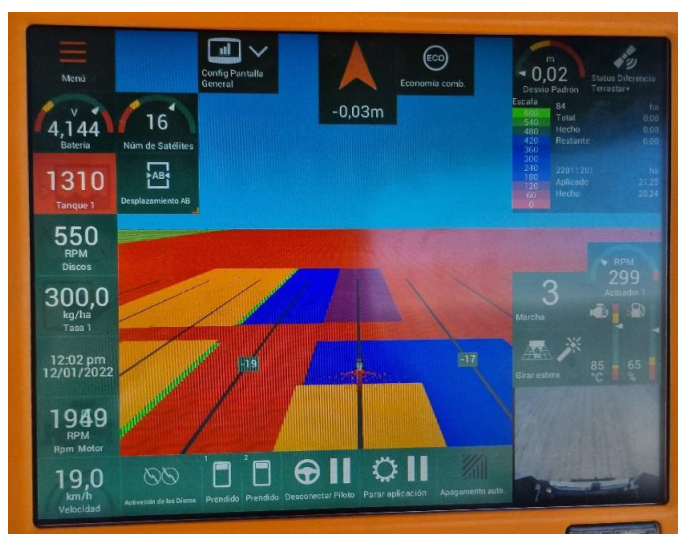
Figura 4. Aplicación de fertilizantes en ensayo en macroparcelas en un sitio de Otumpa (Santiago del Estero) con el cultivo en V3-V4 durante la campaña 2021-2022. Arriba: fertilizadora al voleo autopropulsada. Abajo: monitor de la fertilizadora aplicando dosis de 80 kg N/ha (300 kg nitrodoble/ha), con ancho de aplicación de 36 m y largo de 200 m.
